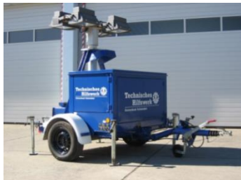
Stromaggregat mit Lichtmast
